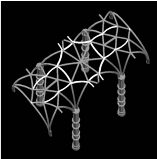
Figure 13 Représentation 3D de la travée de la nef de l'église des Hiéronymites: les nervures courbes au sommet, soulignent les figures géométriques et les lignes d'intersections de la voûte (Genin, 2002)
